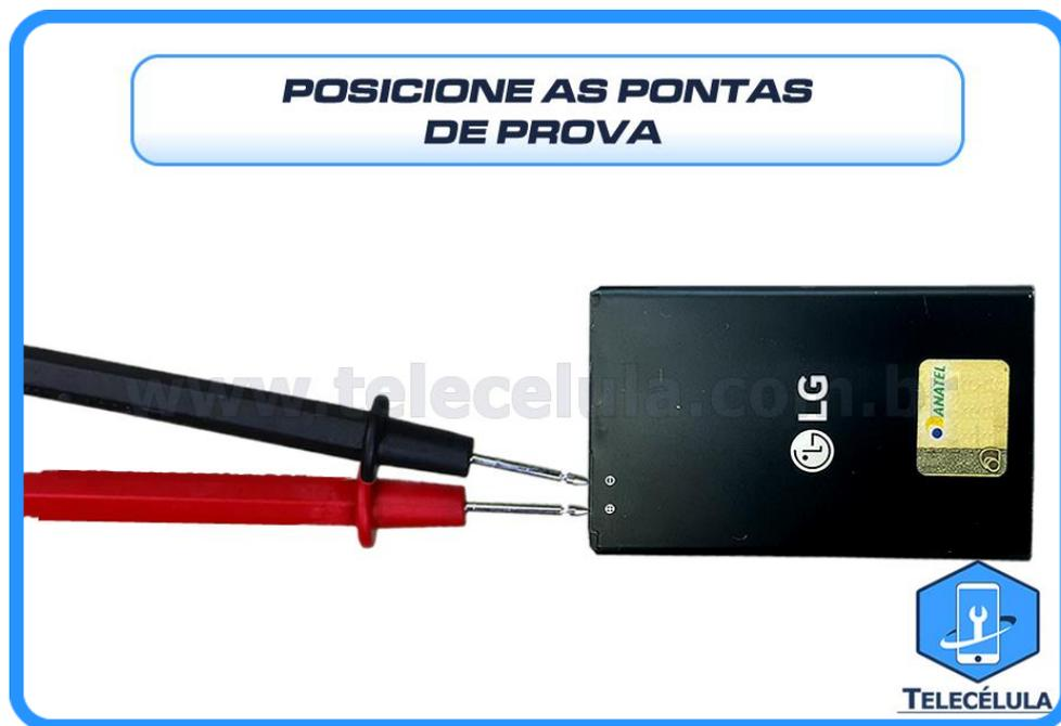
**10.6** Com as pontas de prova posicionadas nos polos da bateria, eleve a tensão gradativamente até atingir no máximo 500mAh. À medida que a corrente for reduzindo eleve a tensão mantendo próximo aos 500mAh (0.5A).
