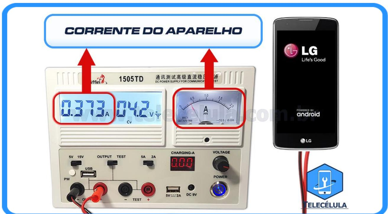
**5.7** Em caso de **curto circuito** a fonte não proverá tensão e corrente, em seguida transmitirá um alerta sonoro juntamente com a exibição da imagem do sinal de curto no display da fonte de alimentação.
